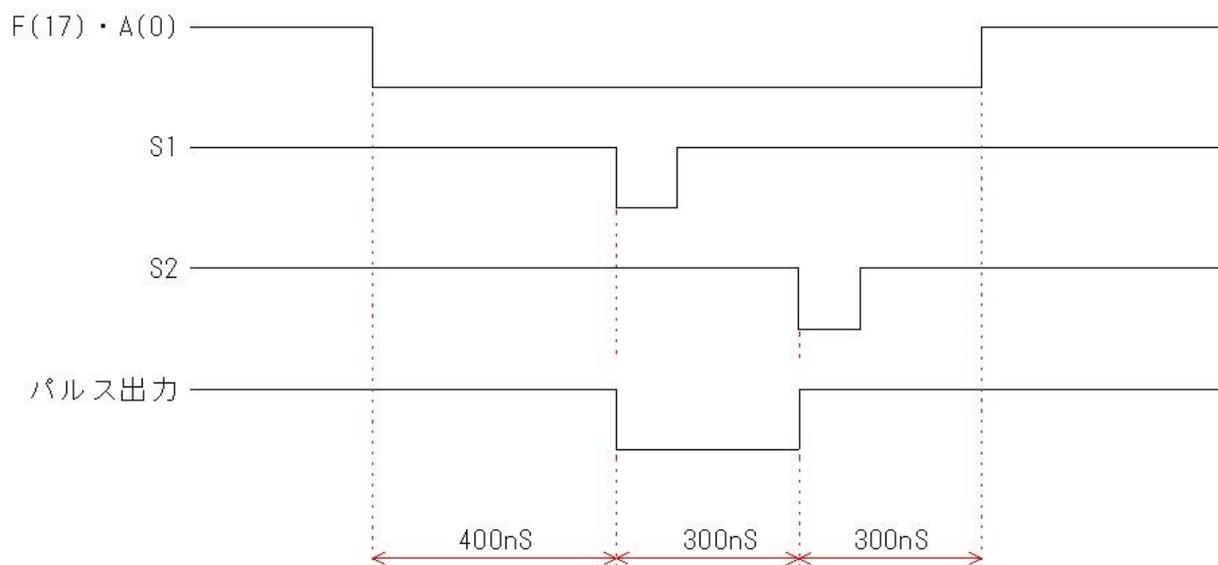
\*このパルス幅は CAMAC 規格のタイミングで作られますが、クレートコントローラーによっては厳密に CAMAC 規格を満たしていないものもあります。その場合、パルス幅はクレートコントローラーに依存します。
